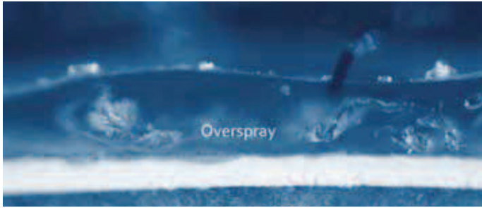
Der Querschliff dieses Lackierfehlers mit bis zu 50 Mikrometer Auflösung zeigt erkennbar Overspray als Fehlerursache.
